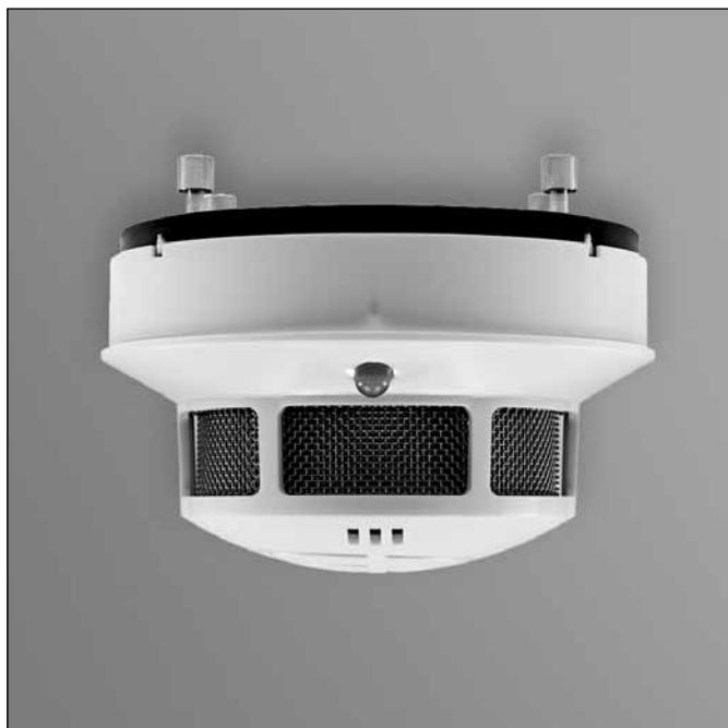
Rauchschalter in Lüftungsleitungen erkennen frühzeitig Rauch und steuern Brand- und Rauchschutzklappen sowie weitere Komponenten der Lüftungsanlage an, um eine Brandausbreitung durch den Luftstrom zu verhindern.
